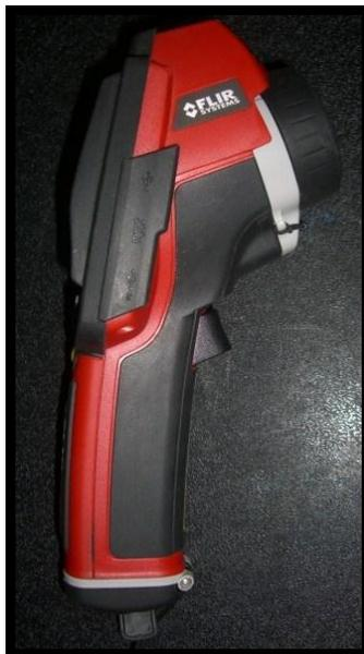
**Fig. 2** Termógrafo usado para la captura de las imágenes presentadas en este trabajo
