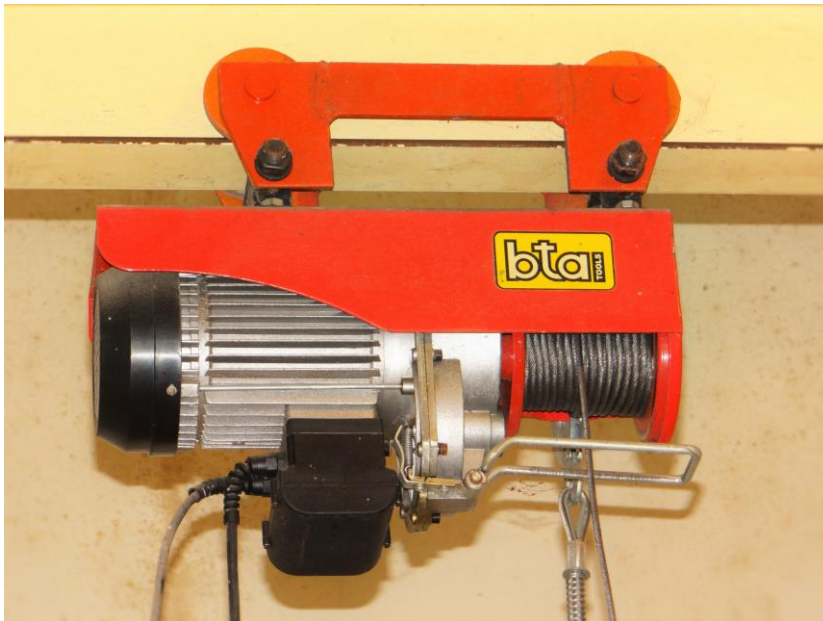
Fig. 2: sistema de elevación y traslado del equino
