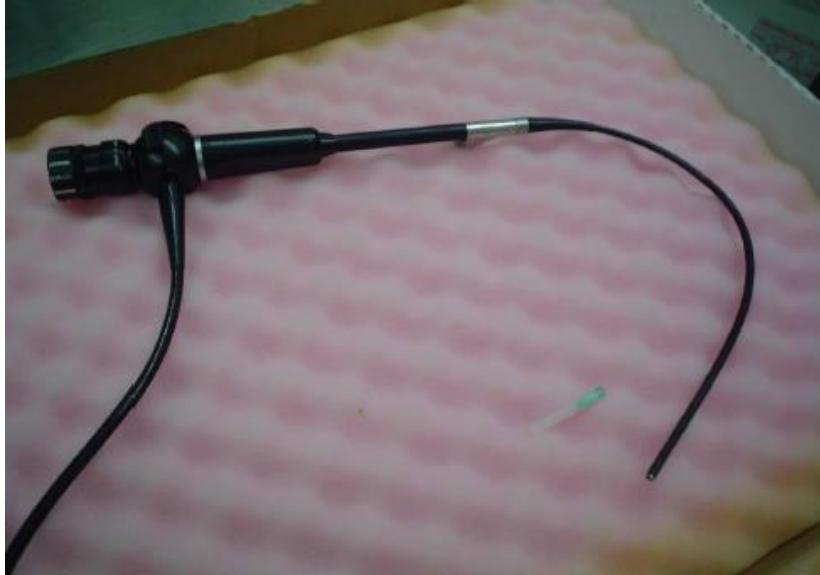
Foto 10 Fibroscopio (obsérvese el diámetro en comparación con la aguja hipodérmica)
