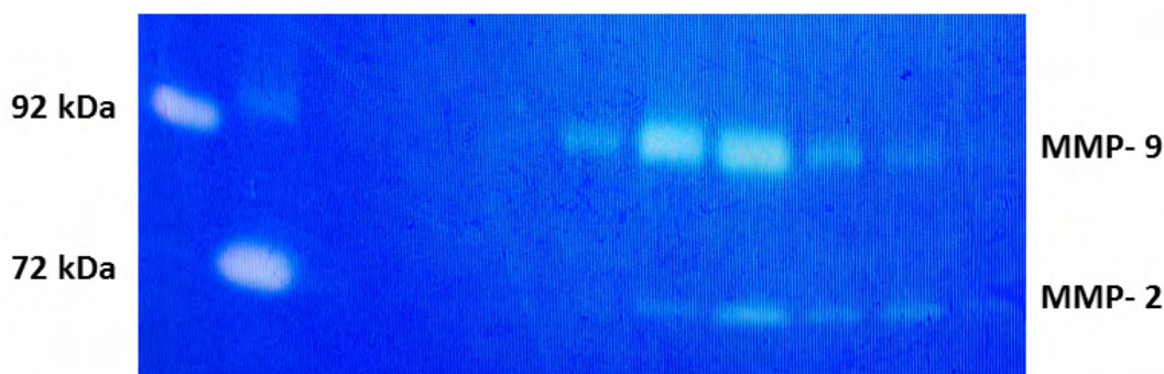
Figura 2. Análisis de la actividad de las MMPs mediante Zimografía en SDS-PAGE 10% con el agregado de 0.2% de gelatina. De izquierda a derecha calle 1 control MMP-9, calle 2 control MMP-2 y calles 2-8 corresponde a diferentes muestras de leche bovina.
