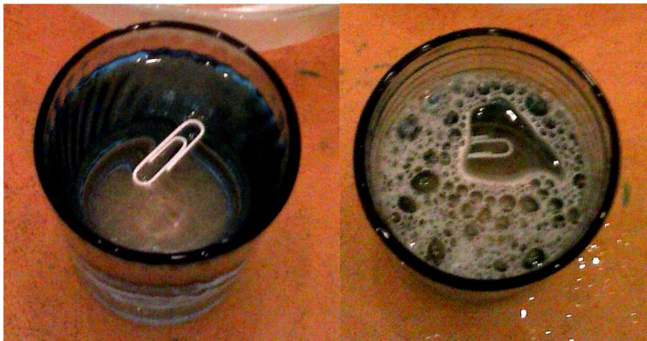
Clip en agua (izquierda) versus clip en una solución acuosa con un tensioactivo (derecha)
