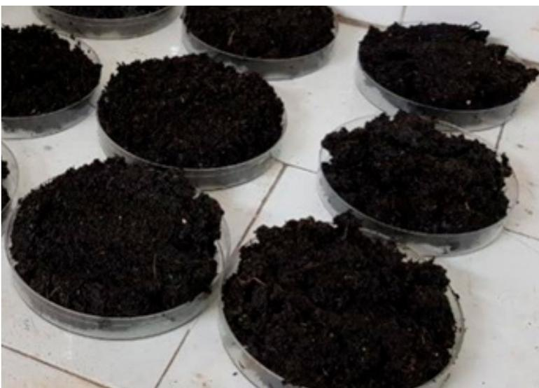
**Fig.3.** Muestra de lodos con distinta antigüedad, sobre los que se determinó el COT.
