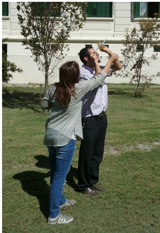
Figura 2: Uso del clinómetro, un operario realiza puntería y el otro lee el valor angular
