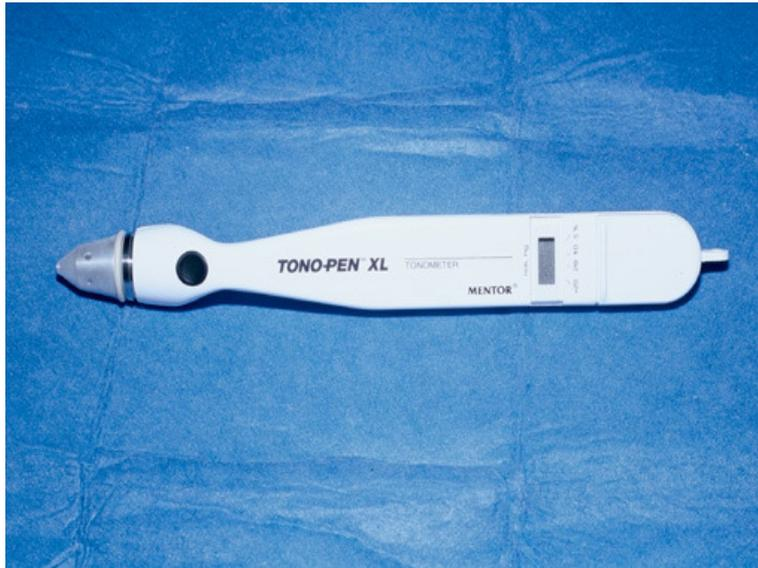
Fig. 3: Tonómetro de aplanación
